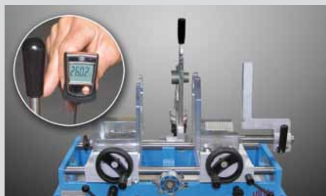
Измерение темп. на сварочном аппарате aquatherm
