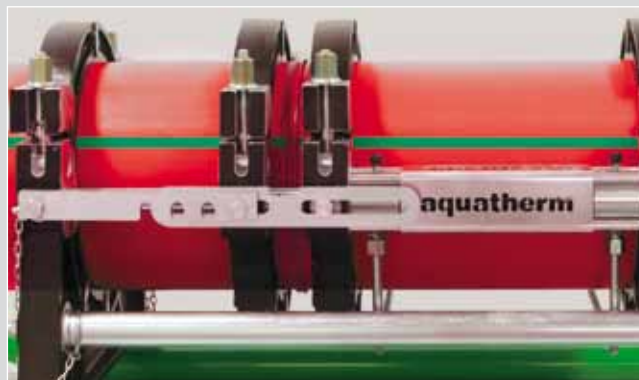
Трубы свести, под давлением дать соединению остыть
