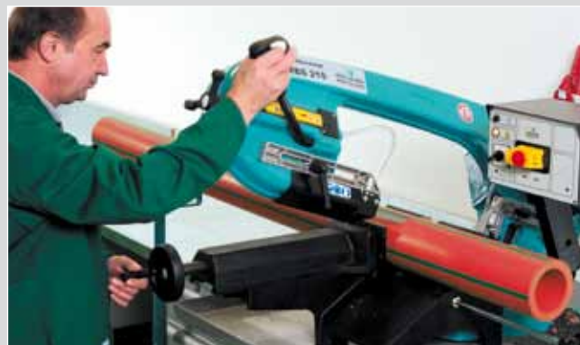
Перед сваркой отрезать трубу на необходимую длину
