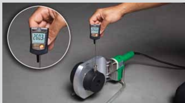
Измерение темп. на ручном сварочном приборе aquatherm (1400 Вт)
